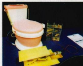
「隨機認便」廁所系統模型，可辨識糞便以知健康，也有加入 UV 燈系統，為廁所消毒。
